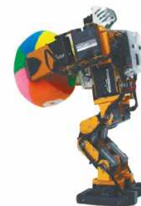
초고속 인지칩을 내장한 로봇이 목표물을 찾아 들어 올리고 있다 사진 제공 KAIST
