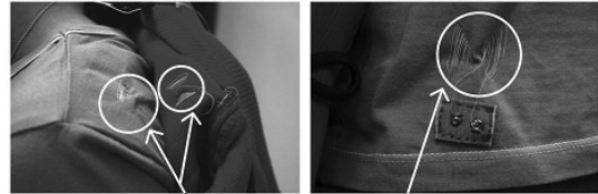
(그림 5) Woven Inductor의 제작
